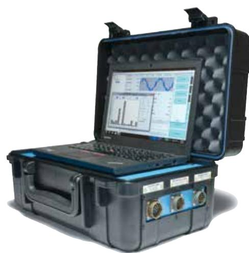
Baker EXP4000 se napaja bilo iz ugradene baterije ili iz mreže, može se direktno priključiti na izvode motora, na kontrolni orman, ili na EP1000 dinamički link motora ako je izведен van kontrolnog ormana. Baker EXP4000 prikuplja podatke kao što su: kvalitet napajanja, performanse mašine, struja, spektar, obrtni moment, pogon sa promenljivom frekvencijom, tranzijenti, efikasnost. Svi prikupljeni podaci se skladište za izradu izveštaja, plana održavanja, kao i analize trenda ponašanja motora.
