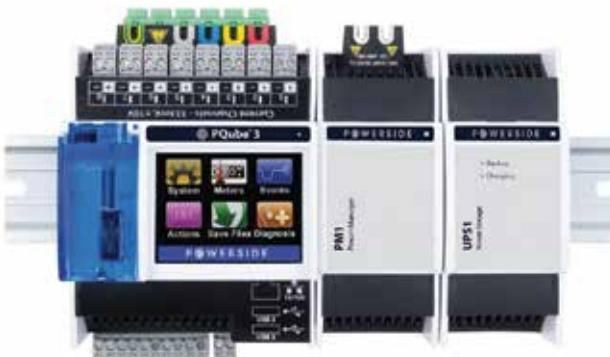
PQube3 je sertifikovani Class A IEC61000-4-30 Ed2 (Ed3) ugradni monitor kvaliteta energije – kompaktni uredaj velikih mogućnosti. Trofazni i monofazni monitoring, 69–480 V fazno, 100–960 V medufazno, 50/60/400 Hz. Četiri analogna ulaza, jedan digitalni ulaz, jedan relezni izlaz. Konfiguracija sa 5 ili 8 strujnih kanala, uz veliki izbor PSL strujnih senzora (5 A, 20 A, 50 A, 100 A, 200 A i više, preko Rogovski kalemova).
