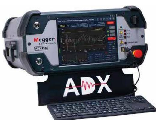
Standardni ADX i AWA-IV modeli za statička ispitivanja imaju ispitne napone do 2 kV, 4 kV, 6 kV, 12 kV i 15 kV. Opcioni Power Pack omogućava rad do 40 kV. Rad sa instrumentima je preko ekrana osetljivog na dodir. Sva merenja se skladište u internoj memoriji instrumenta, a dostupan je i softver za izradu izveštaja o ispitivanju.
