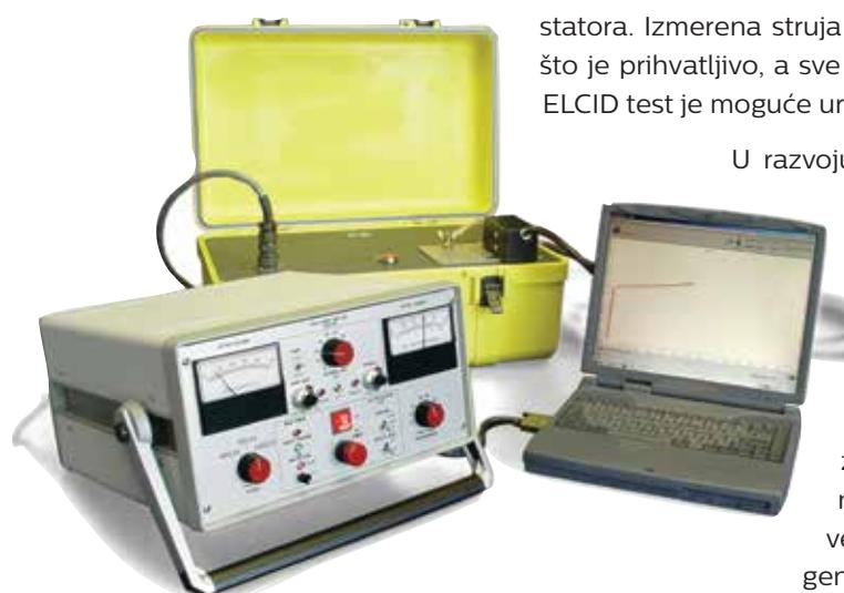
elektromotora. Uredaj generiše DC ramp napon do 60 kV definisanog porasta i pritom meri struju i analizira U/I krivu. Analizom krive procenjuje se stanje izolacije, otkriva se oštećenja, kvarovi i mehanizmi starenja. Ponovljenim ispitivanjem poredi se nova kriva sa prethodnom i zaključuje o stanju namotaja. Metoda otkriva statorske namotaje koji se približavaju kvaru a ne oštećuje samu izolaciju. Metoda se godinama primenjuje u USA i definisana je standardom IEEE 95-2002.
