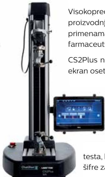
Visokoprecizni digitalni tester sile CS2Plus je dizajniran tako da pojednostavi ispitivanja kako u procesu proizvodnje, tako i u laboratorijskim uslovima. Pogodan za ispitivanja do 5 kN, CS2Plus se ističe u raznim primenama i prilikom testiranja širokog spektra materijala, kao što su: plastika, guma, kozmetika, pakovanja, farmaceutski proizvodi, elektronske komponente i drvo.
