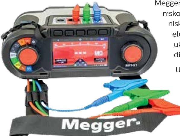
Megger MFT-X1 je nova generacija višefunkcionalnih uređaja za ispitivanje niskonaponskih električnih instalacija. Namjenjen je za upotrebu na svim niskonaponskim električnim instalacijama, uključujući tačke punjenja električnih vozila i kućne solarne sisteme. Opseg ispitnih mogućnosti uključuje puštanje u rad instalacija i periodično održavanje, kao i detaljnu dijagnostiku kvarova.
