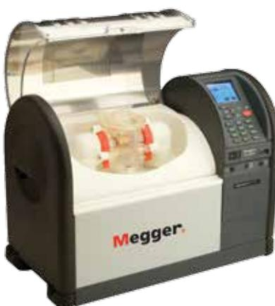
Kod električne opreme izolovane uljem (transformatori, prekidači), prva i najlakša metoda provere stanja izolacije je ispitivanje dielektrične probognosti izolacionog ulja. Novi uredaji Megger serije OTS su namenjeni radu na terenu i u laboratorijama, kompaktne dizajne i laki za korišćenje, sa velikim LCD kolor displejem i memorisanim ispitnim procedurama po svim važećim standardima.
